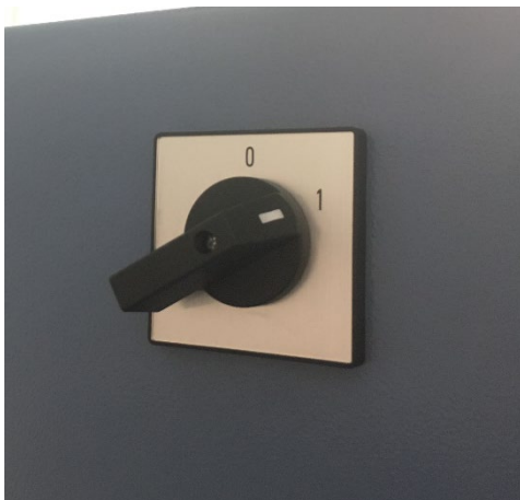
Position 0 : presse éteinte Position 1 : presse allumée
