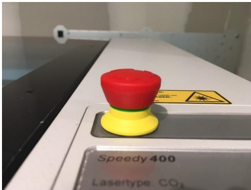
Bouton d'arrêt d'urgence armé > je vois la bague verte = je peux utiliser la machine
